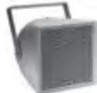
Всепогодная акустическая система, 2-х полосная, рупорная, LF1x8", HF1x3/4", 500 Вт, 8 Ом, с трансформатором 70/100 В, 200/100/50/25 Вт, светло-серый корпус.
